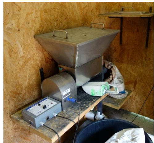
Abbildung 6: Zusatzdosierer, mit Aufsatz
